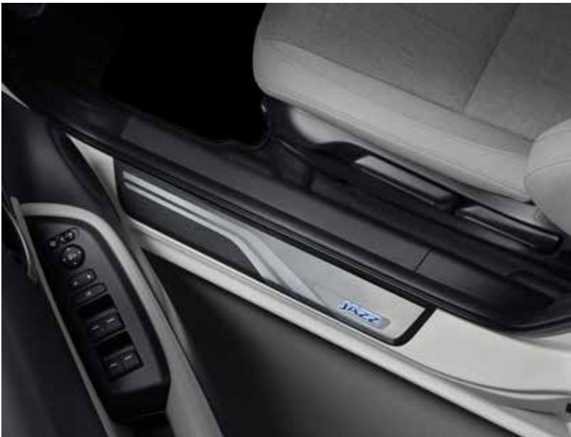
TRÖSKELLISTER MED BELYSNING De upplysta tröskellisterna är tillverkade av borstat rostfritt stål och har en Jazz-logotyp som belyses med vitt ljus. De skyddar dörrens insida mot märken och repor. Setet innehåller två tröskellister med belysning.
